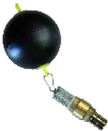
Plavajoč sesalni odjem 1" z kroglo, filtrom in nep. ventilom
